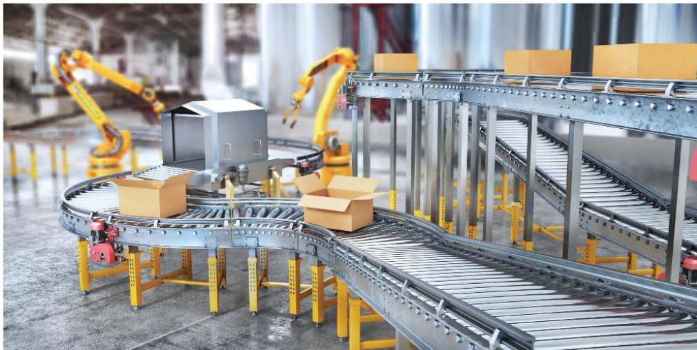
รูปที่ 5.11 หุ่นยนต์ที่กำลังบรรจุสิ่งของบนสายพานการลำเลียง [32]
