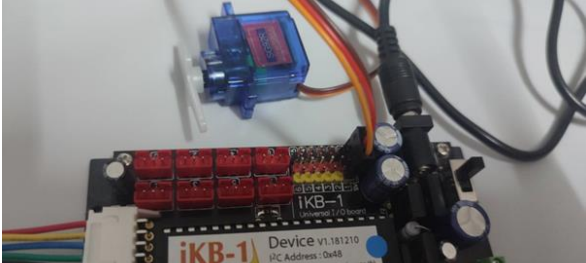
รูปที่ 2.33 การต่อกับบอร์ด iKB-1 ทาง I2C เพื่อควบคุม servo motor
