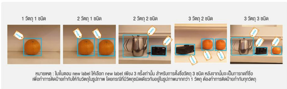
รูปที่ 3.19 ตัวอย่างการถ่ายภาพและติดป้ายกำกับ สำหรับการเรียนรู้แบบ Object Detection
