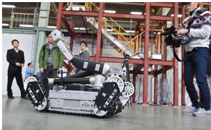
รูปที่ 5.13 หุ่นยนต์ที่ถูกใช้สำรวจโรงไฟฟ้านิวเคลียร์เมืองฟูกูชิม่า ประเทศญี่ปุ่น [34]
