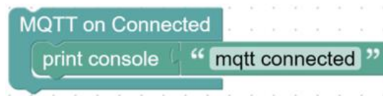
รูปที่ 4.6 โค้ดสำหรับการพิมพ์ข้อความ "mqtt connected" ผ่านบล็อก MQTT on Connected
