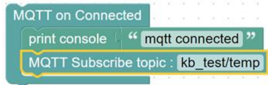
รูปที่ 4.7 สร้างการเชื่อมสำหรับการสื่อสารด้วย Topic ที่ชื่อ "kb_test/temp"
