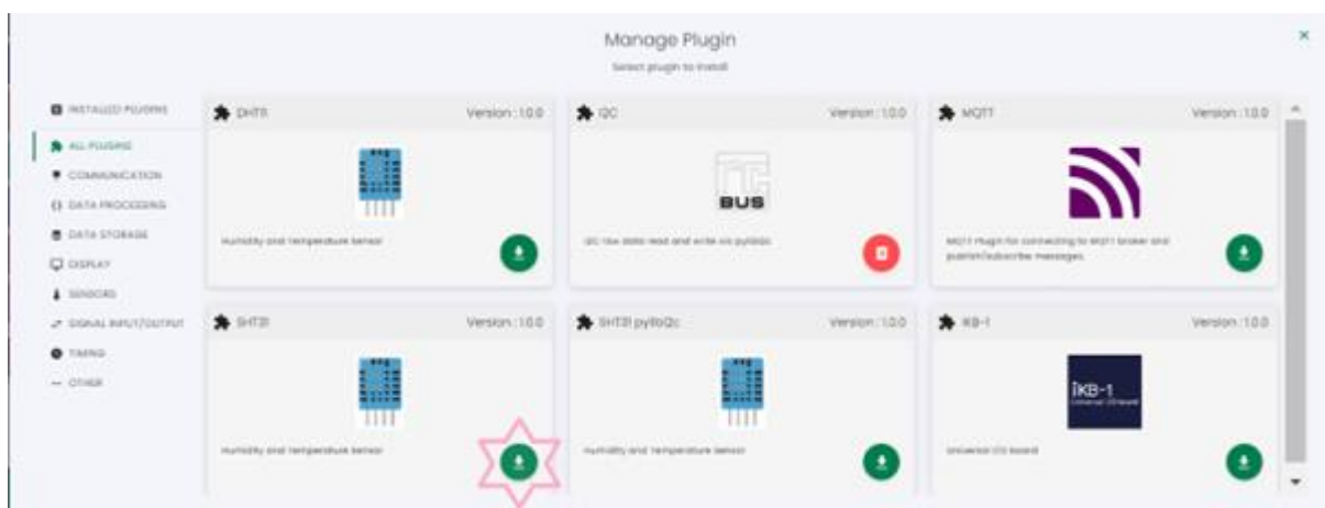
รูปที่ 2.27 การติดตั้ง Plugin SHT31
